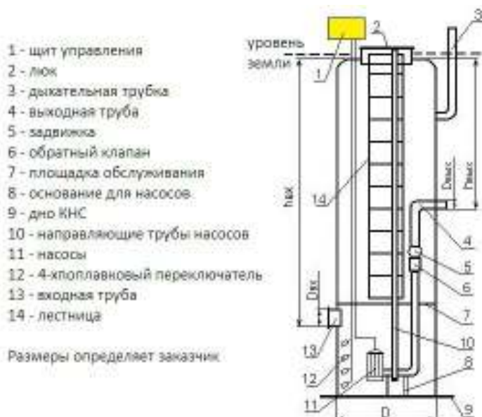
Рисунок 2.98 – Общая схема устройства «КНС» с погружными насосами
